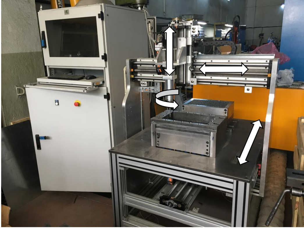
Şekil 10. Çok noktalı formlama kalıbı pim ayar CNC tezgâhı ve kontrol ünitesi
