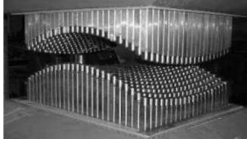
Şekil 1. Çok noktalı kalıp örneği
